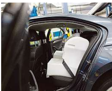
TESTOVÁNÍ TAKZVANÝ PAN WASSERMANN SLOUŽÍ K TESTOVÁNÍ BRZD.
